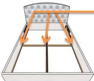
Бруск распределите снизу (как на картинке), прикрутите уголками и саморезами 19 мм в места, указанные стрелками.
