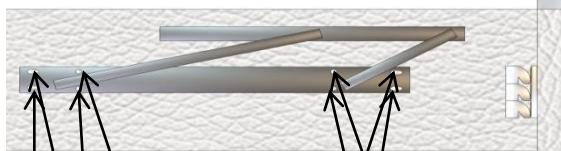
Прикрутите по разметке (точки), подъемный механизм, винтами M6x20 мм.
